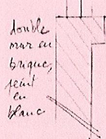
Rietveld utilise la technique traditionnelle du double mur de brique. Mais le béton et l'acier sont également utilisés -
